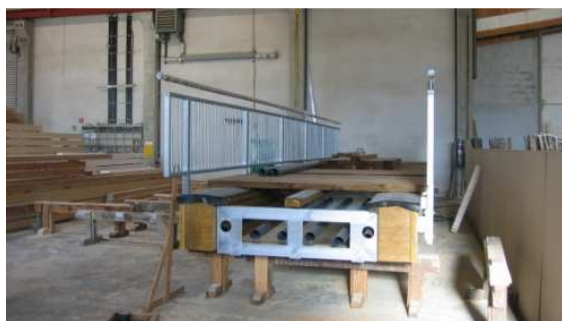
Bild 3: Ansicht während der Vorfertigung im Werk: BSH-Träger sind oben beidseitig abge­schragt und mit einer Rhepanolfolie vor ein­dringender Feuchtigkeit geschützt. Außerdem ist zwischen den Trägern eine Führung für Versorgungsleitungen angebracht.
